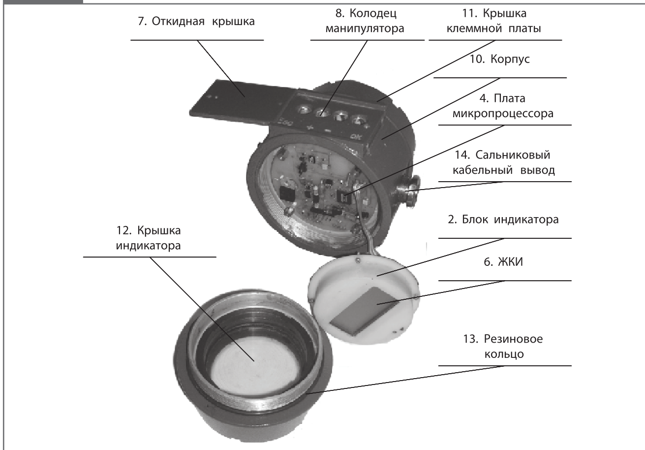
Устройство электронного блока Сапфир-22МР, Сапфир-22МР-ДДИ (ДДА)
