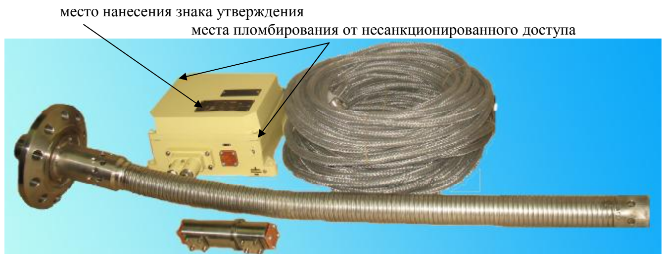
Рисунок 1- Внешний вид уровнемера.
