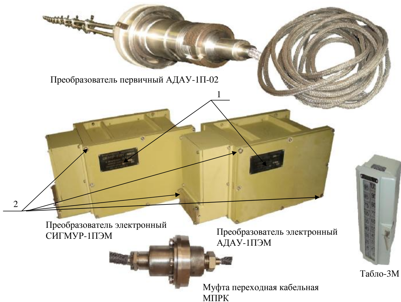
Рисунок 1- Внешний вид уровнемера аналого-дискретного акустического АДАУ-1
